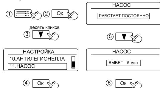
Рисунок 24. Настройка времени выбега циркуляционного насоса
