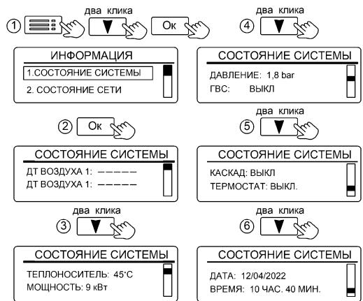
Рисунок 28. Вид вкладки «СОСТОЯНИЕ СИСТЕМЫ»
