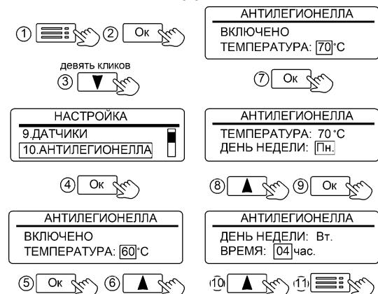
Рисунок 14. Настройка времени включения режима «АНТИЛЕГИОНЭЛЛА»
