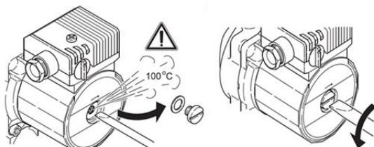
Рисунок 34. Проверка вала насоса
