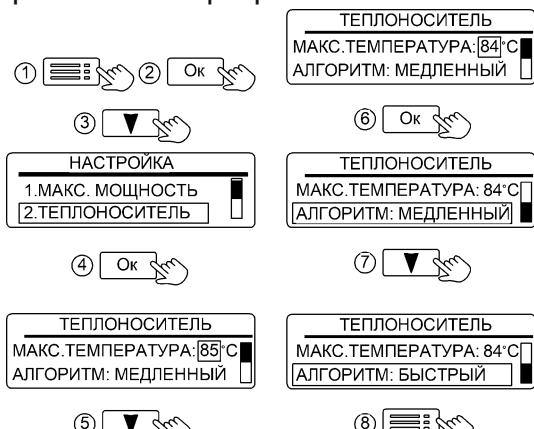
Рисунок 17. Настройка ограничения максимальной температуры теплоносителя
