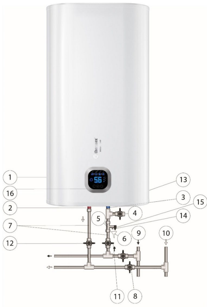
Рисунок 1-2. Схема подключения ЭВН к водопроводу в вертикальном и горизонтальном положении
